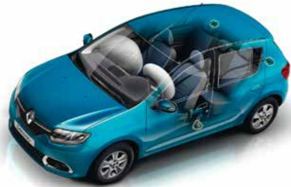
**Protección.** Airbags delanteros para conductor y acompañante. Cinturones de seguridad delanteros inerciales, ajustables en altura. Cinturones de seguridad traseros laterales inerciales y central ventral.
